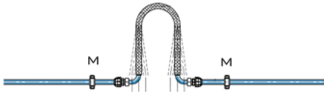
Expansielus, gebruik gemaakt van flexibele leiding
