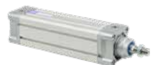
voorbeeld: cilinder Ø40 - slag 200mm en beweegt 20 keer per minuut 70.4 NL/min
